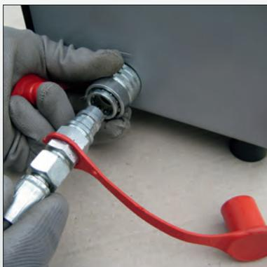
Einfaches Anschließen des Hydraulikschlauches per Schnellverschluss
